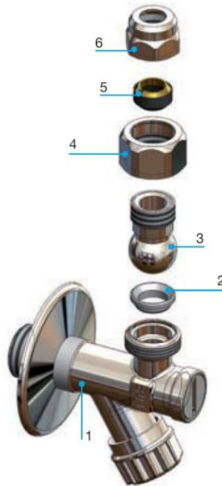
Per il corretto montaggio dei collegamenti rigidi sottolavabo è necessario attenersi alla sequenza sopra indicata, verificando scrupolosamente il verso di assemblaggio di cartuccia e guarnizioni.
