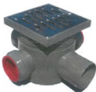
Sifon pardoseală 3 intrari D40mm si iesire D50mm
