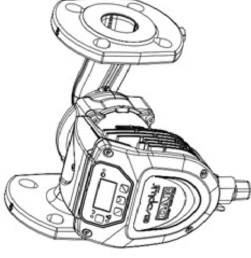
Figura 2: Instalare pe tubaturi orizontale
