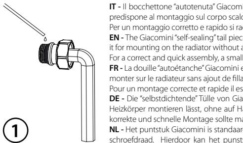
**IT** - Il bocchettone "autotenuta" Giacomini è fornito già dotato di un elemento di tenuta in materiale elastomerico che lo predispone al montaggio sul corpo scaldante senza aggiunta di canapa, pasta o altri materiali di tenuta.
