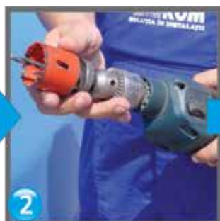
Bormașina cu freză drill press/ дрель с фрезой
